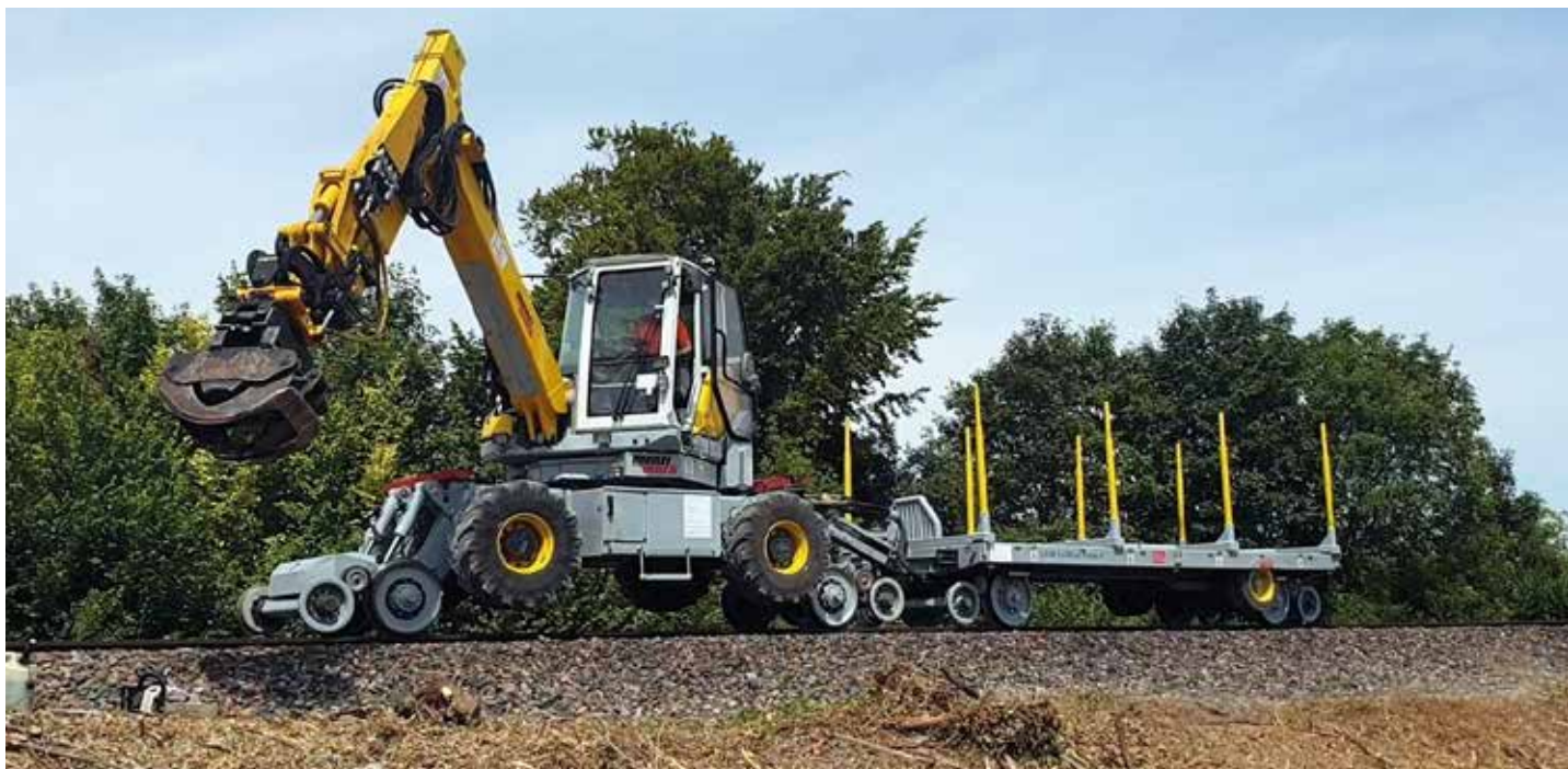
Ensemble pelle M545+RAF32 en mode rail
