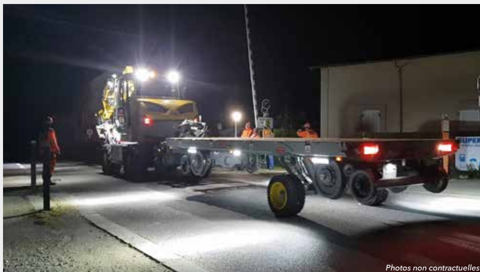
Ensemble pelle M545+RAF32 en mode route
